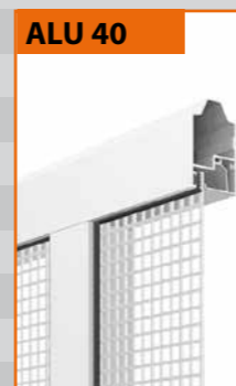
ALU 40 Einwandig, perforiertes Aluminiumblech (20 mm) rund perforiert (40% Luftdurchlässigkeit)
