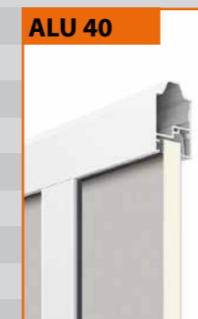
ALU 40 Doppelwandig, geschlossene Füllung, Sandwich-Aufbau (20 mm), außen Alu-Glattblech, innen Stucco-Design
