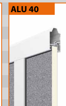
ALU 40 Doppelwandig, geschlossene Füllung, Sandwich-Aufbau (20 mm), innen und außen Stucco-Design
